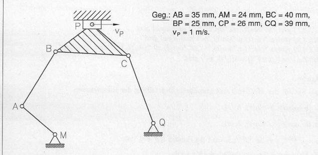
6. Aufgabe Das dargestellte Schubkurbelgetriebe wird an der Kurbel MA angetrieben. Ermitteln Sie für diese Lage sämtliche Geschwindigkeiten und Beschleunigungen!
